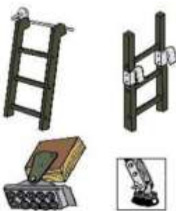
Fig. 5: Sistemas de fijación y apoyo
