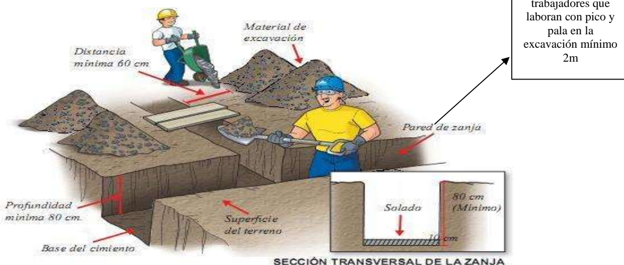
Distanciamiento de trabajadores en excavaciones
