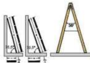
Fig. 4: Inclinación de la escalera
