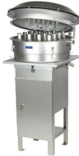
**Ilustración 2. Muestreador Hi-Vol de PM<sub>10</sub>**
