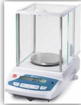
**Ilustración 4. Balanza Analítica OHAUS PA-214-CO**
