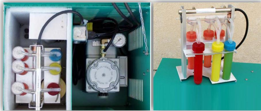
**Ilustración 7. Muestreador de Gases tipo RAC**
