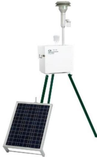
**Ilustración 5. Muestreadores Low-Vol PM<sub>2.5</sub>**
