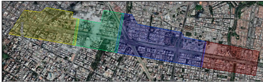
Figura 71. Zonas plan de vuelo del M300 para captura de datos LiDAR
