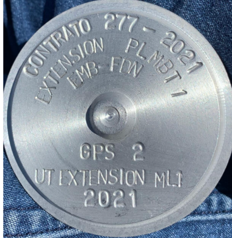
Figura 12. Placa de materialización de puntos GPS Fuente: Unión Temporal Extensión Metro Línea 1
