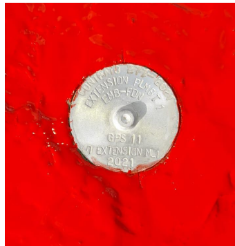
Figura 11. Materialización punto GPS Fuente Unión Temporal Extensión Metro Línea 1
