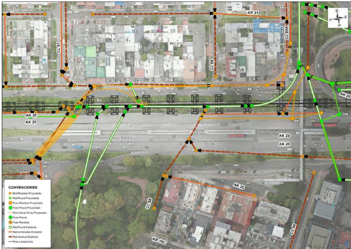
Figura 65. Traslado red residual y pluvial sistema del Virrey
