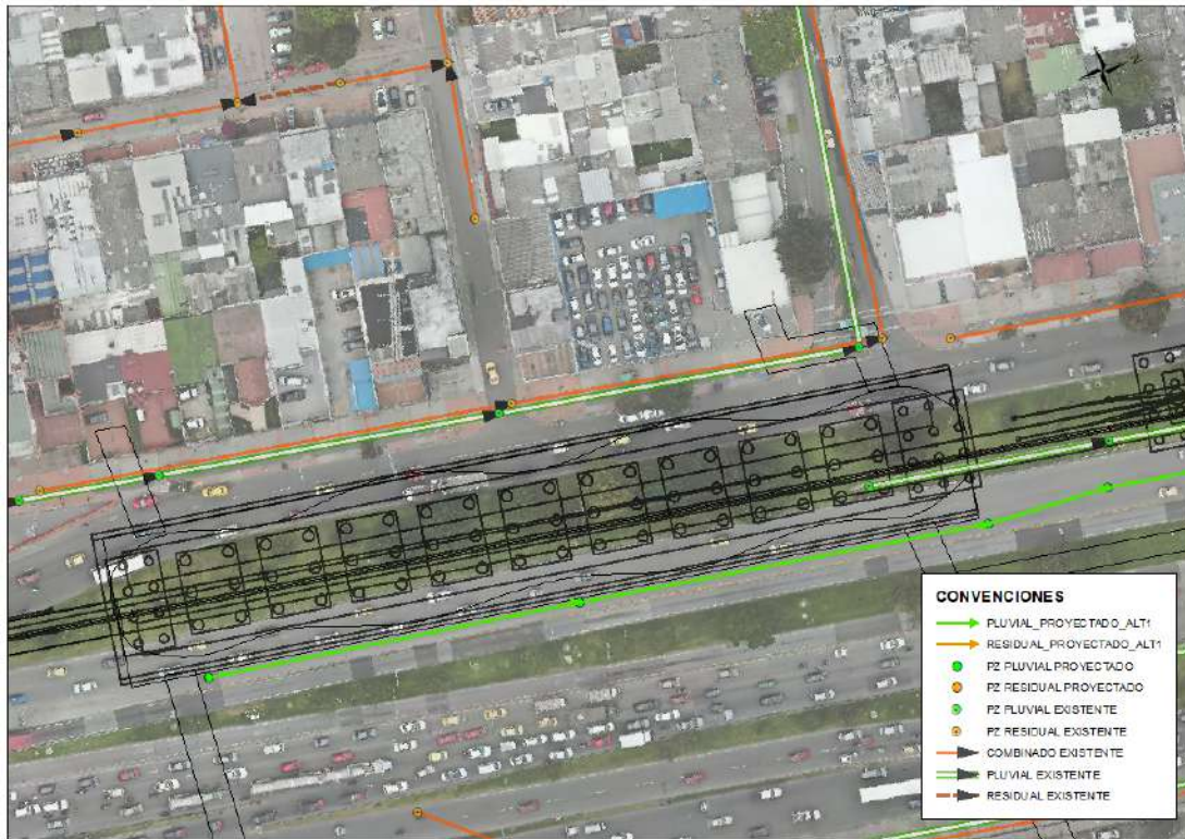
Figura 54. Traslado redes alcantarillado Estación Calle 102
