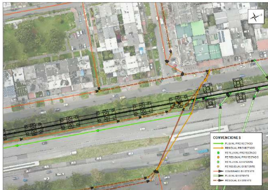
Figura 68. Traslado red pluvial sistema derecho de la estación calle 82 hasta el Virrey
