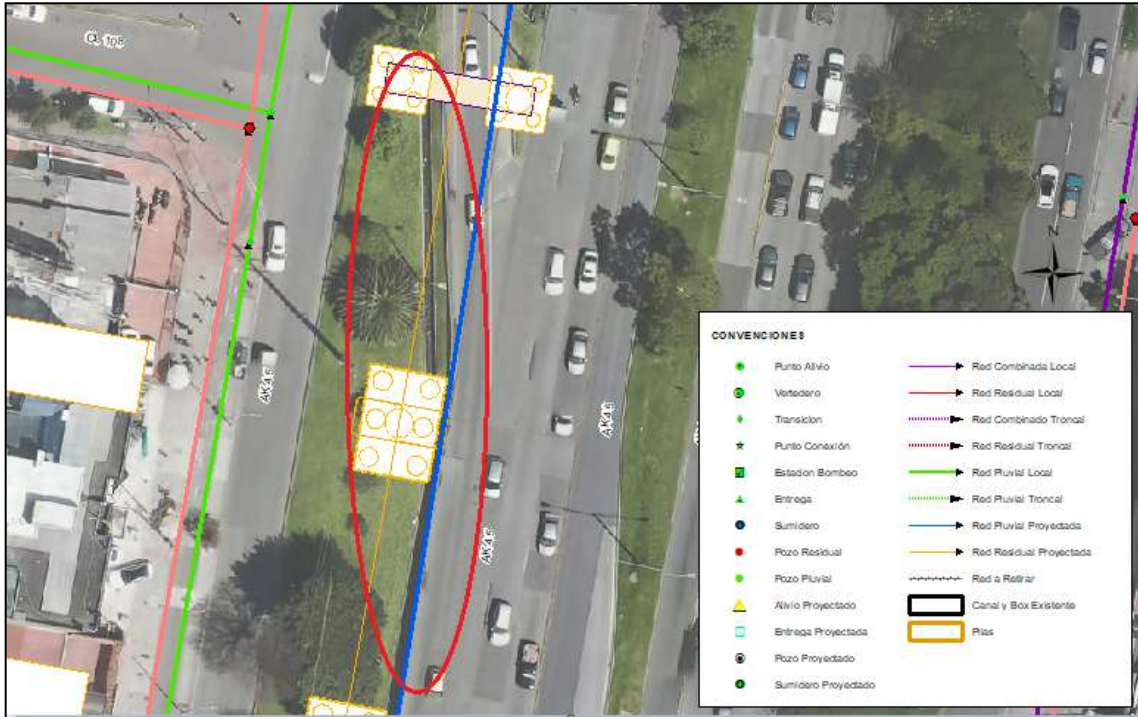
Figura 34. Interferencia canal de drenaje Autopista Norte Calle 106
