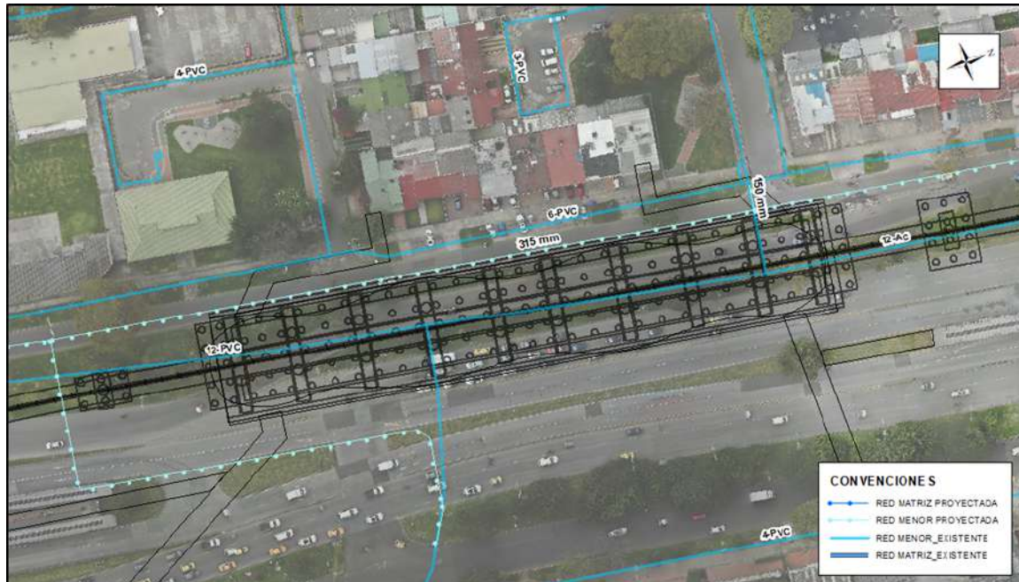
Figura 18. Solución interferencias acueducto Estación Calle 82
