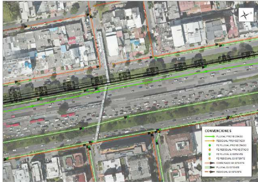
Figura 61. Desvío canal de drenaje CII 104 a CII 106
