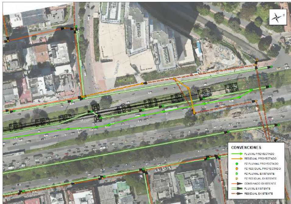
Figura 62. Desvío canal de drenaje CII 106 a CII 108
