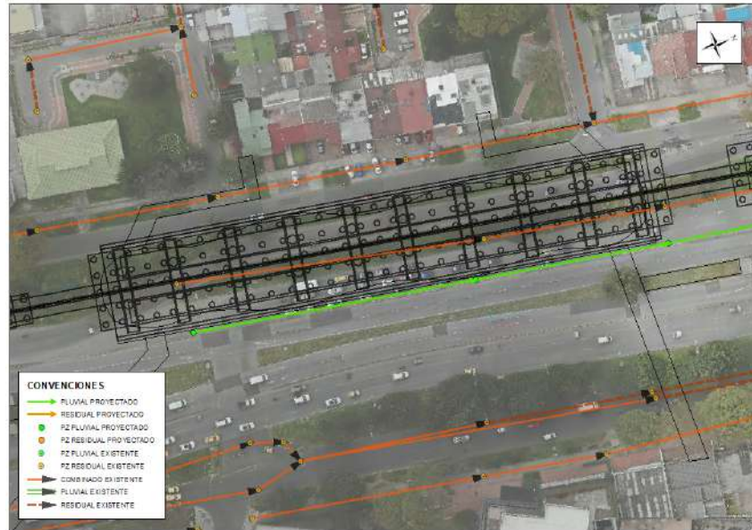
Figura 58. Traslado de redes de alcantarillado Estación Calle 82
