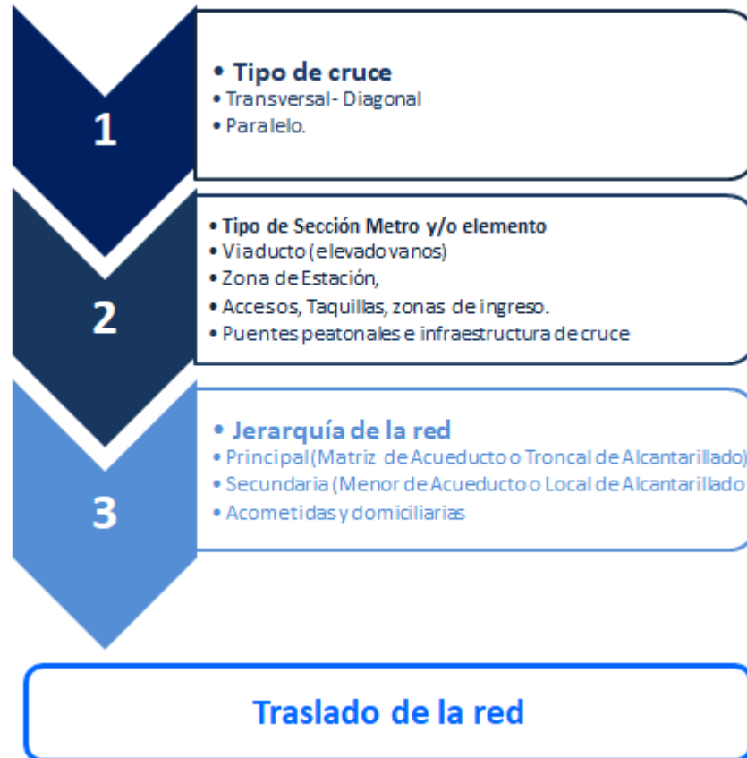
Figura 4. Criterios para la identificación de interferencias y definición de redes a trasladada
