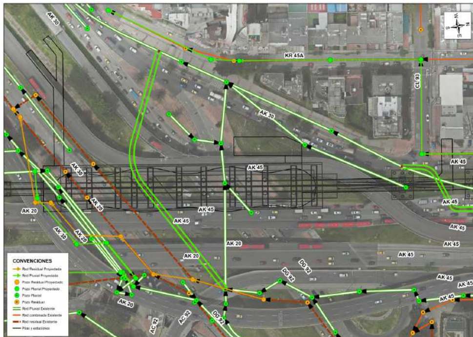
Figura 55. Traslado box culvert La Castellana Estación Calle 92
