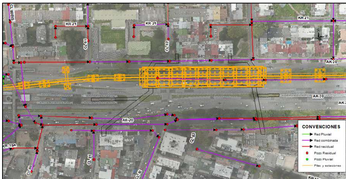
Figura 40. Interferencia red combinada y residual por renovación de espacio público y accesos- CI 80 Bis - CI 83A - Costado Occidental
