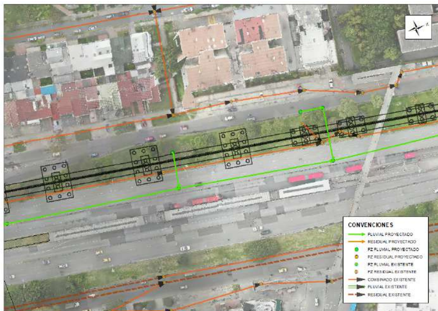
Figura 66. Traslado red pluvial sistema derecho de la estación calle 82 hasta el Virrey
