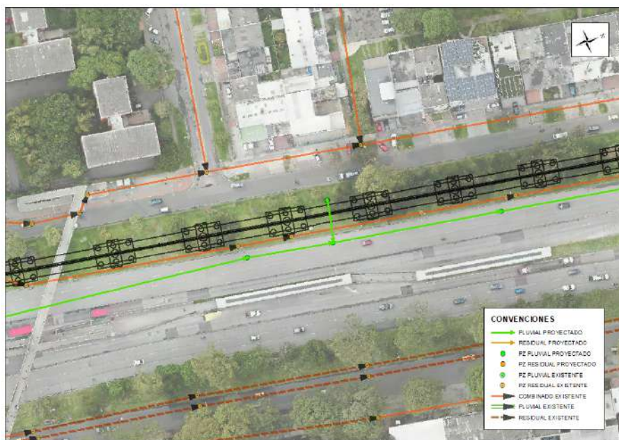
Figura 67. Traslado red pluvial sistema derecho de la estación calle 82 hasta el Virrey
