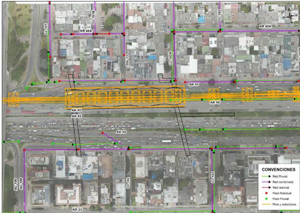
Figura 44. Interferencia red residual y pluvial por renovación de espacio público y accesos - CI 100 - CI 103 - Costado Oriental
