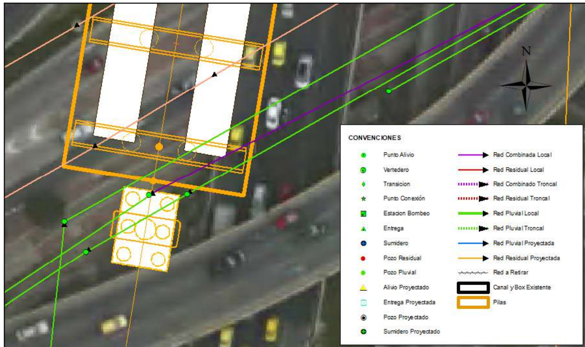
Figura 30. Interferencia descarga deprimido Calle 92
