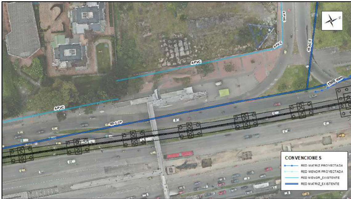
Figura 19. Alineamiento Línea refuerzo Tibitoc CII 97 - CII 100
