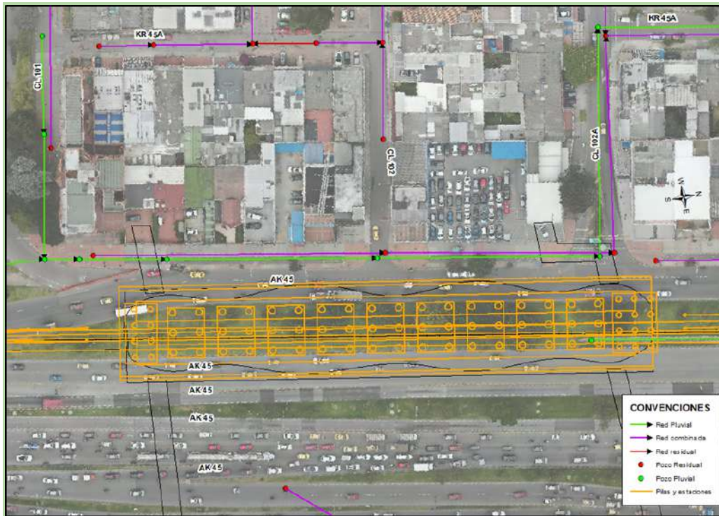
Figura 43. Interferencia red combinada y pluvial por renovación de espacio público y accesos - CI 101 - CI 102A - Costado Occidental
