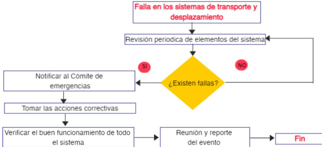
Figura 74. Procedimiento operativo para falla en los sistemas de transporte y desplazamiento
