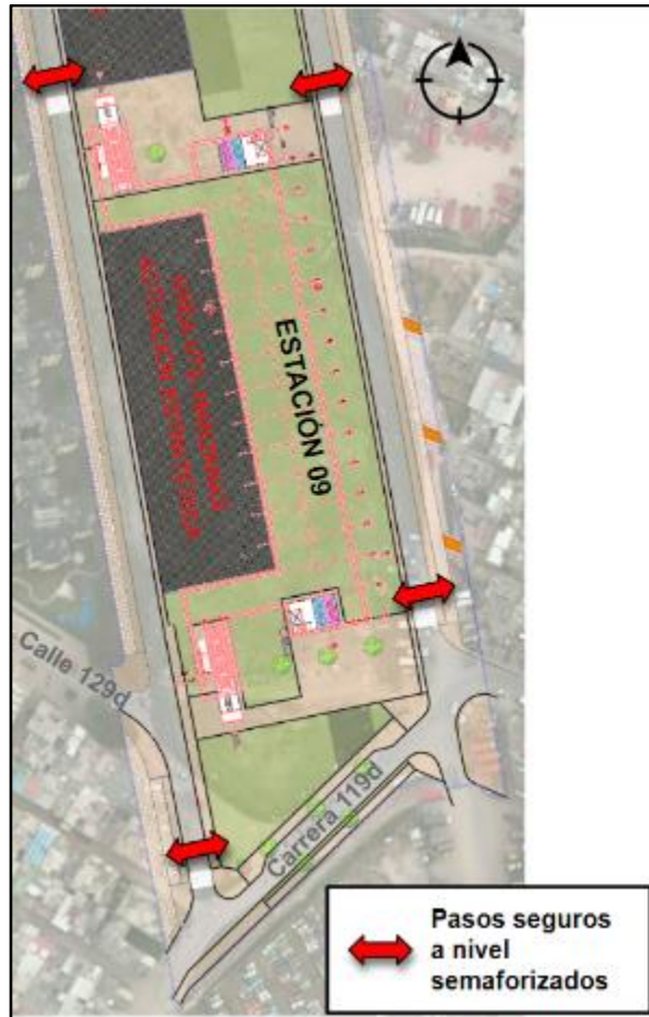
Figura 234. Pasos peatonales semaforizados Estación 9 Fuente: UT MOVIUS 2022
