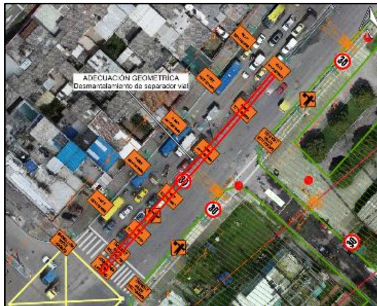
Figura 290. Adecuaciones Geométricas en Estación 7 - Etapa 1. Fuente: UT MOVIUS 2022
