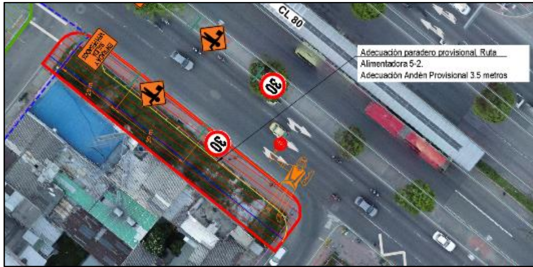
Figura 286. Adecuaciones Geométricas en Estación 6 - Etapa 1. Fuente: UT MOVIUS 2022
