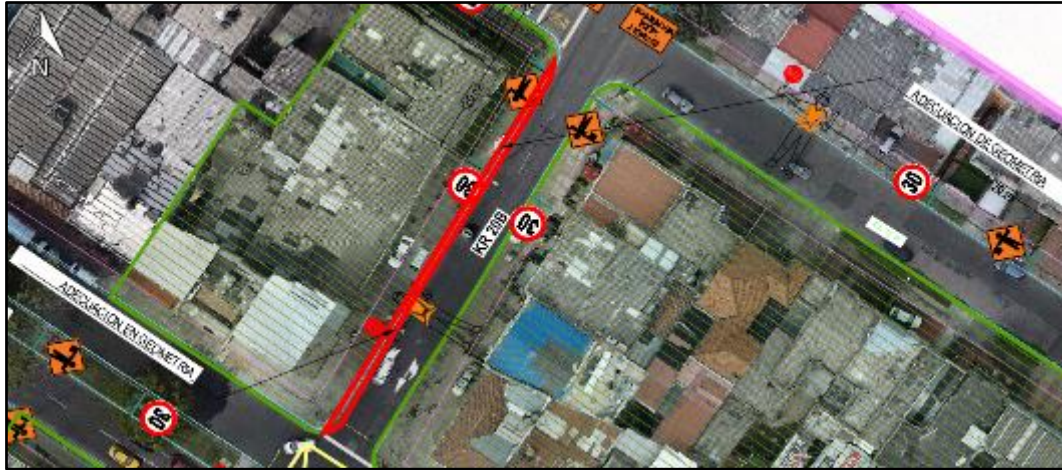
Figura 271. Adecuación geométrica sobre la KR 20B en Estación 1 - Etapa 1.
