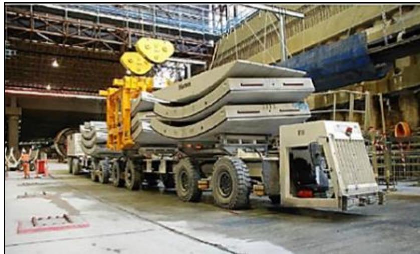
Fotografía 23. Vehículo típico para transporte de dovelas Fuente: UT MOVIUS 2022
