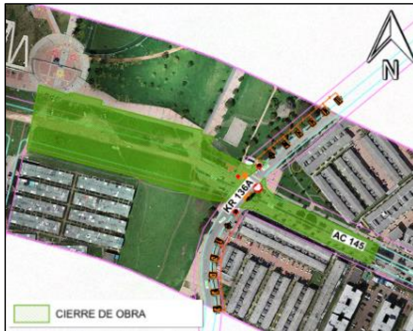
Figura 301. Cierres de obra para el Ingreso de Tuneladora - Etapa 1. Fuente: UT MOVIUS 2022
