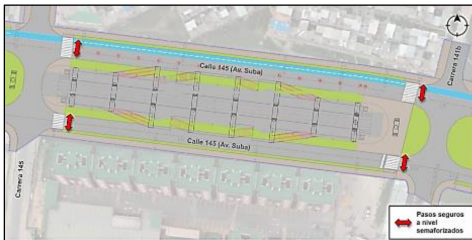
Figura 236. Pasos peatonales semaforizados Estación 11 Fuente: UT MOVIUS 2022
