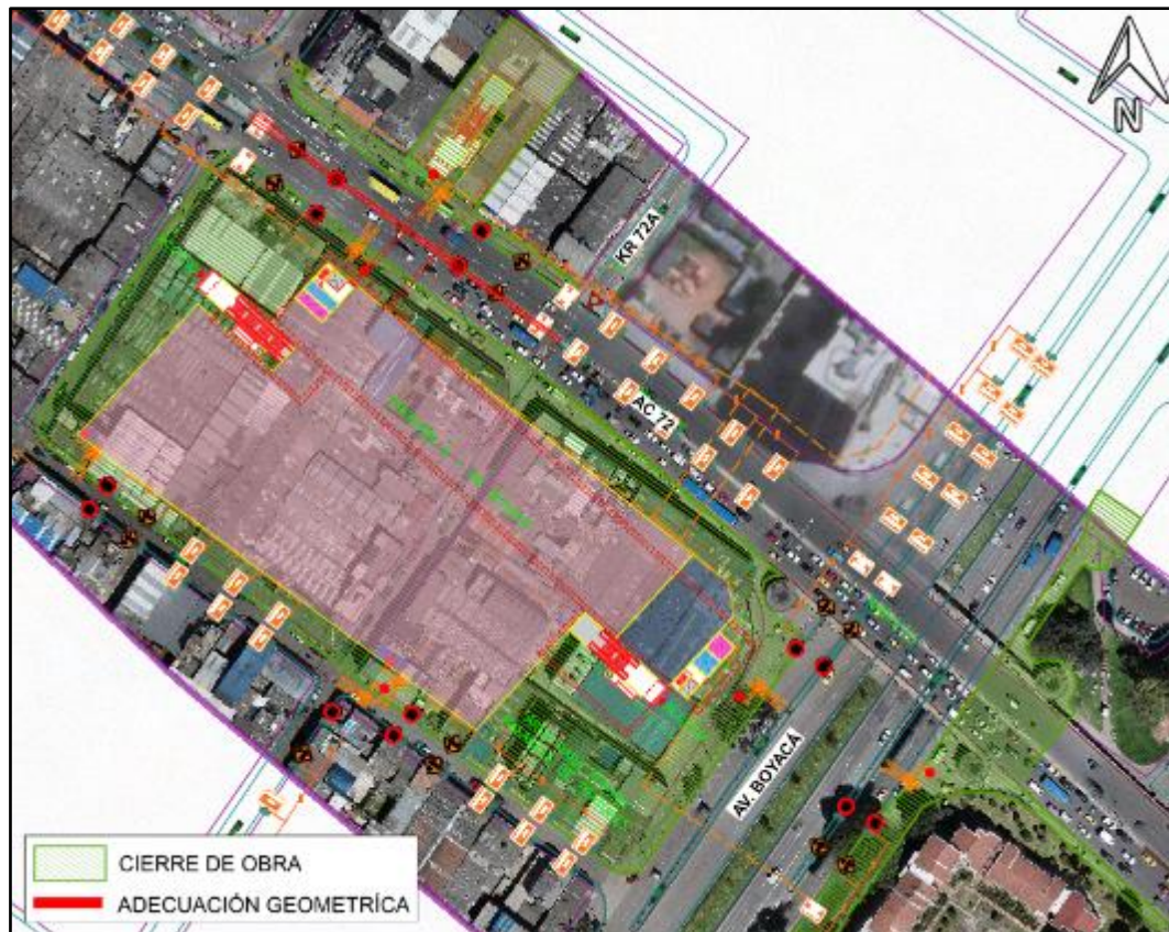
Figura 282. Cierres de obra en Estación 4 - Etapa 1.
