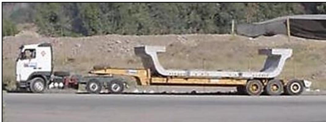
Figura 338. Transporte de dovelas mediante remolques de cama baja Fuente: UT MOVIUS 2022
