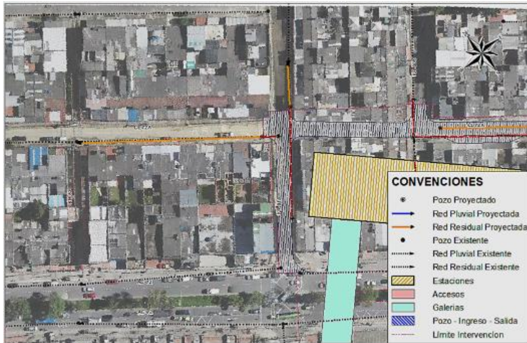
Figura 148. Traslado redes de alcantarillado Estación 5 Calle 72A y Carrera 81A - Red Residual. Fuente: UT MOVIUS 2022
