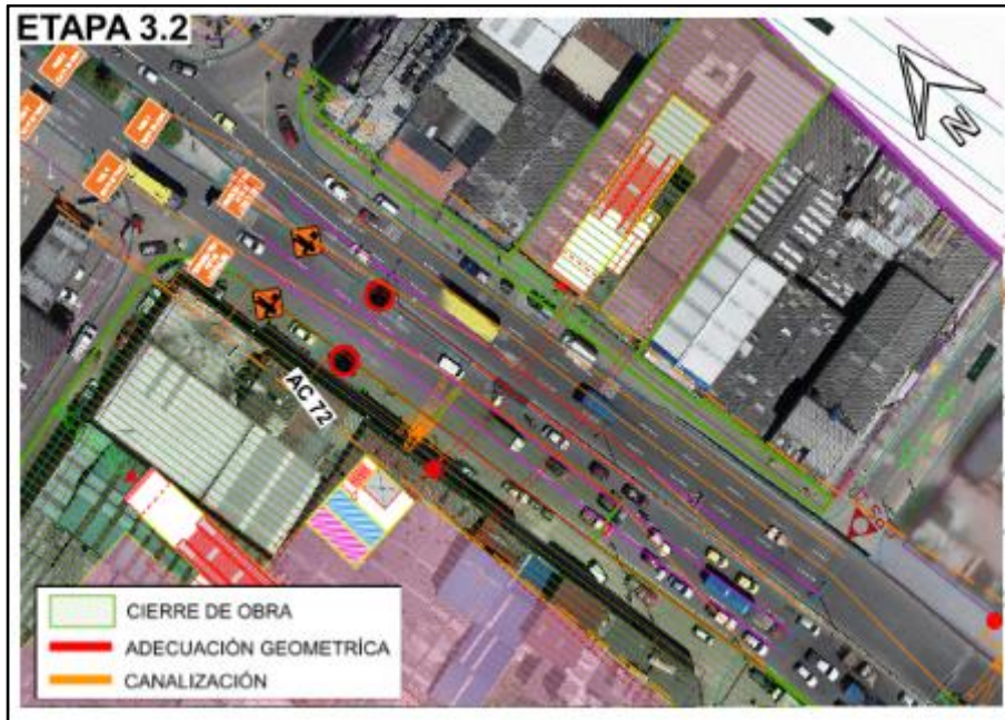
Figura 283. Adecuaciones Geométricas en Estación 4 - Etapa 3. Fuente: UT MOVIUS 2022
