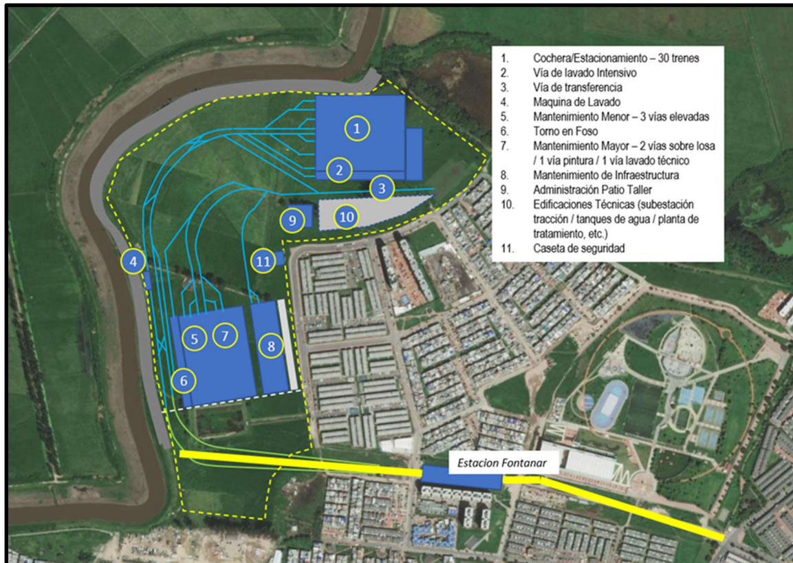
Figura 8. Instalaciones del patio-taller de la L2MB.
