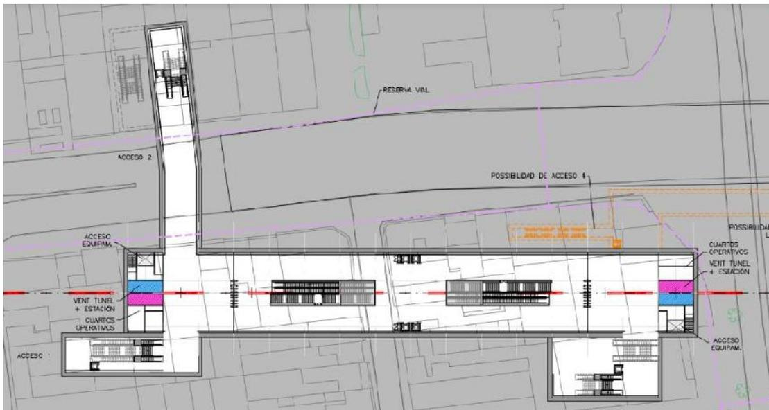
Figura 40. Módulos de acceso tipos 1 y 2 en Estación 4 (Av. Boyacá)
