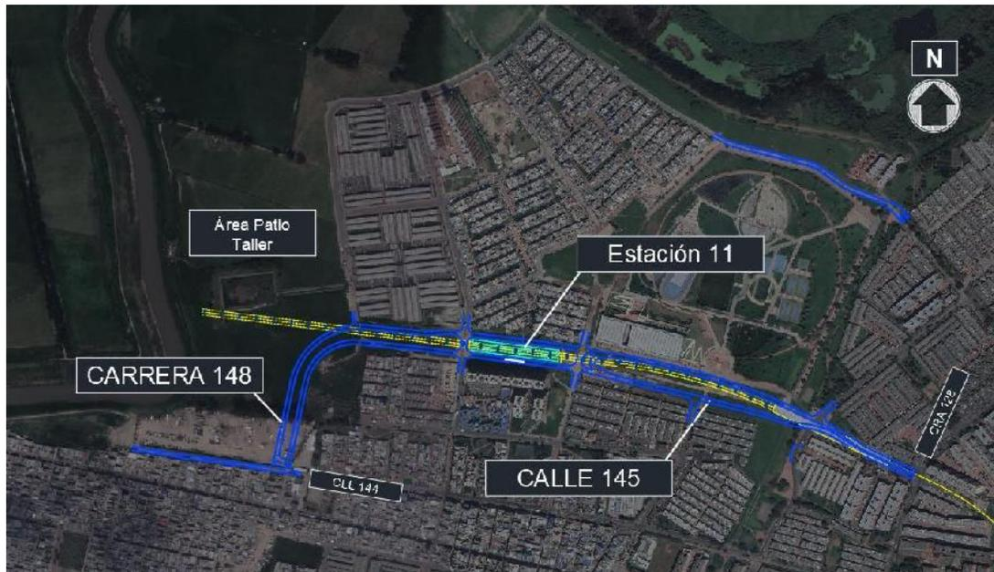
Figura 63. Trazado en planta prolongación calle 145
