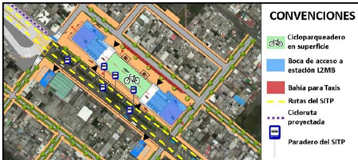
Figura 73. Detalle de integración multimodal en la Estación 5 de la L2MB
