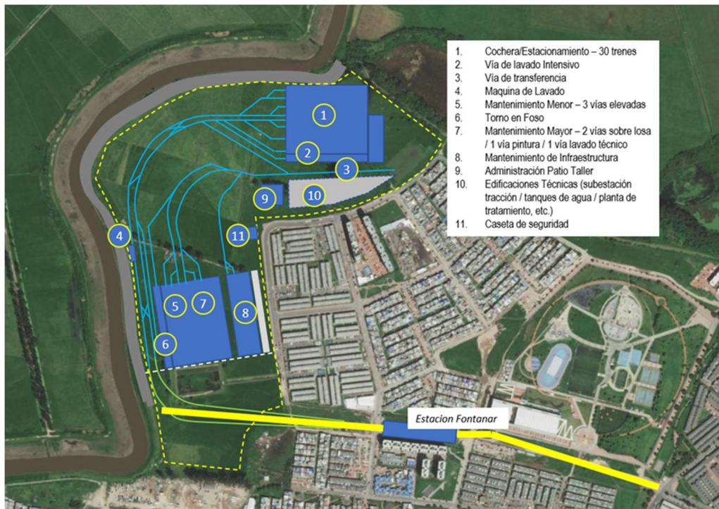
Figura 5. Instalaciones del patio-taller de la L2MB
