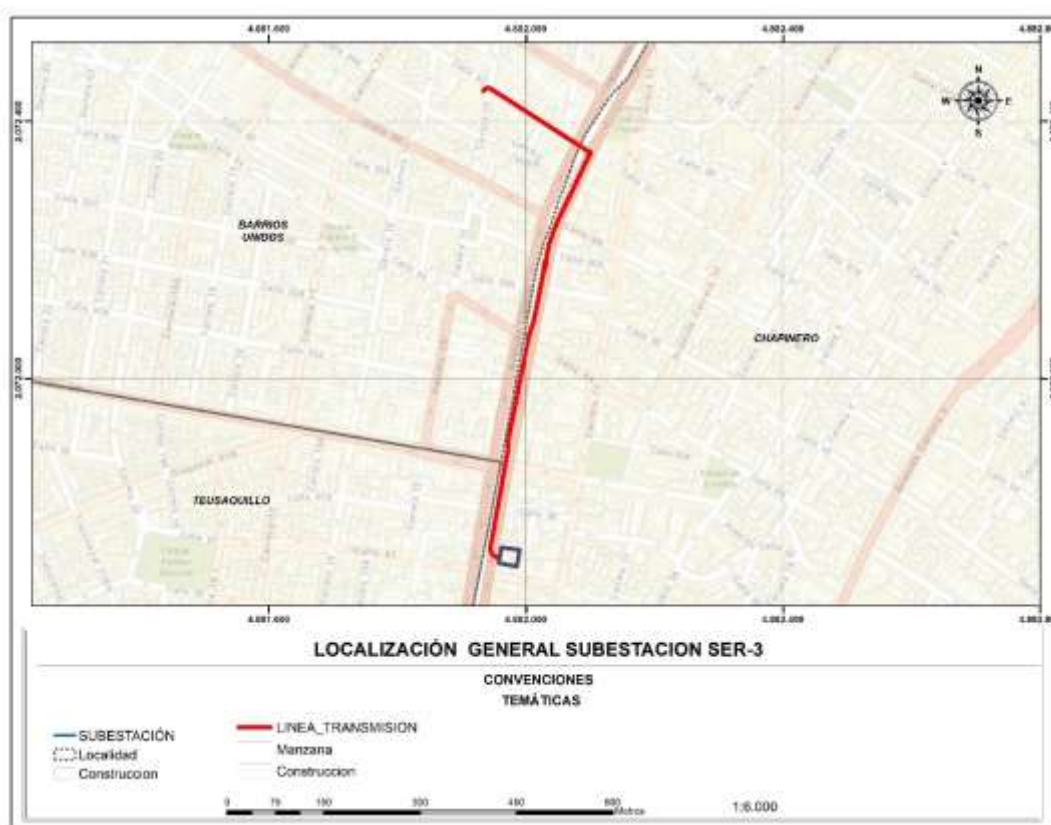
Figura 2 Ubicación de subestaciones eléctricas a 115 kV
