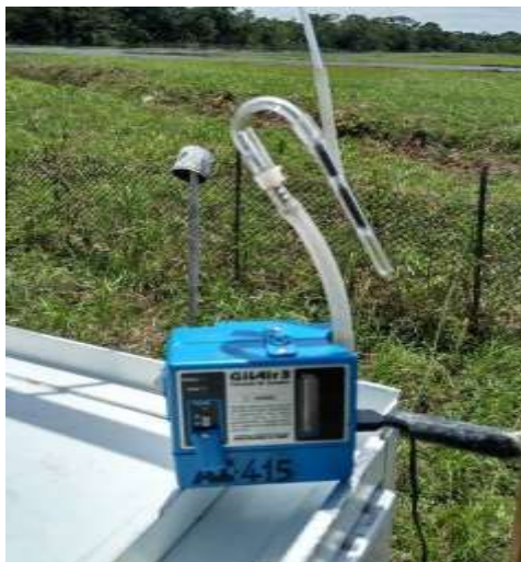
Fotografía 8 Equipo de muestreo utilizado para las mediciones de VOC
