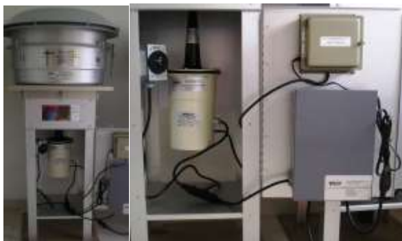
Fotografía 3 Equipo Muestreador de alto volumen para la determinación de PM10
