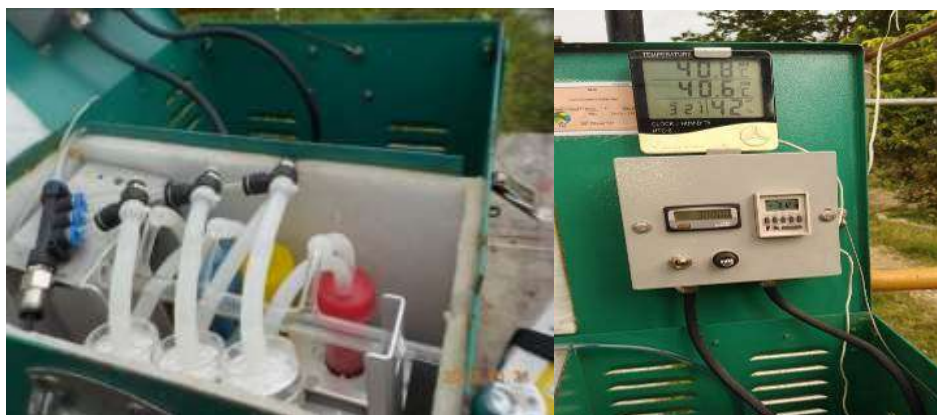
Fotografía 6 Equipo utilizado para las mediciones de gases NO 2 y SO 2
