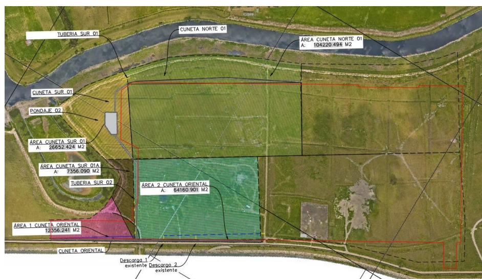
Figura 33 Concepto hidrológico del drenaje de la plataforma
