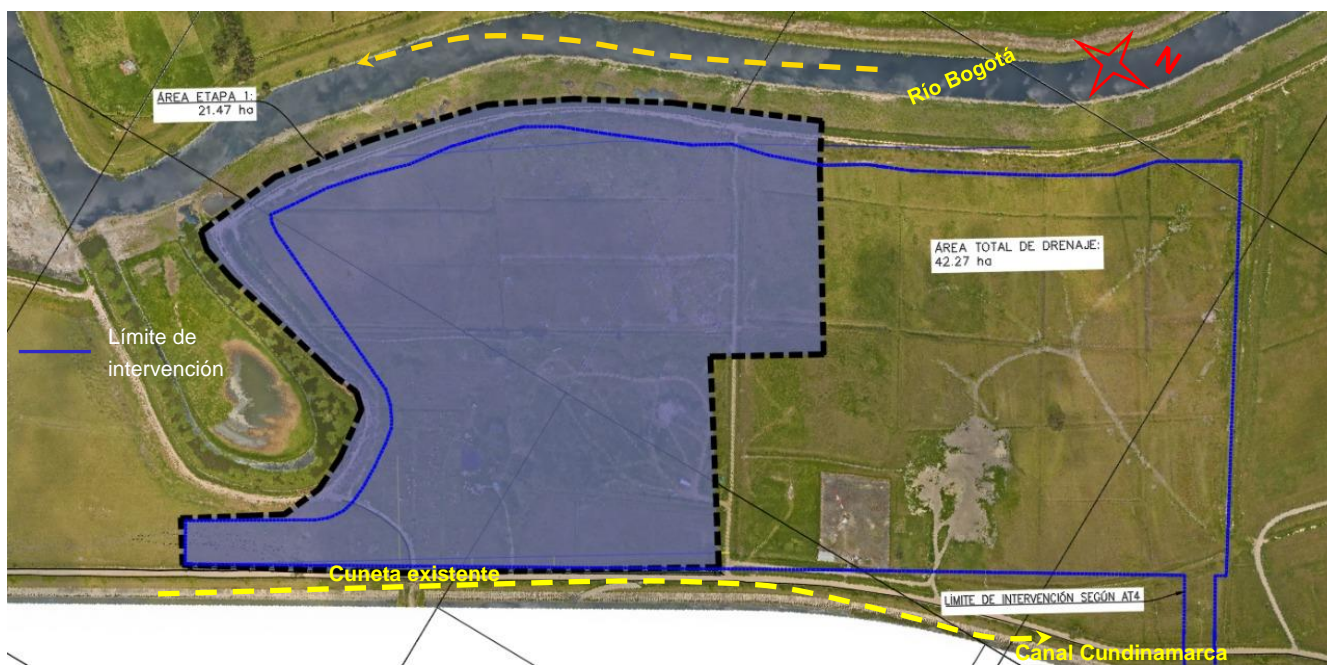
Figura 29 Área de drenaje de la plataforma
