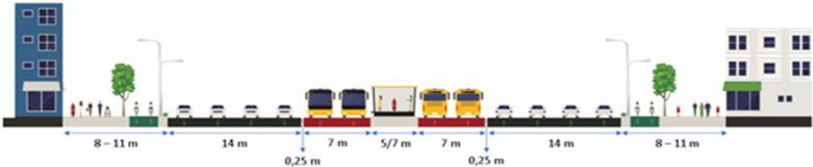
Figura 5. Perfil con estación
