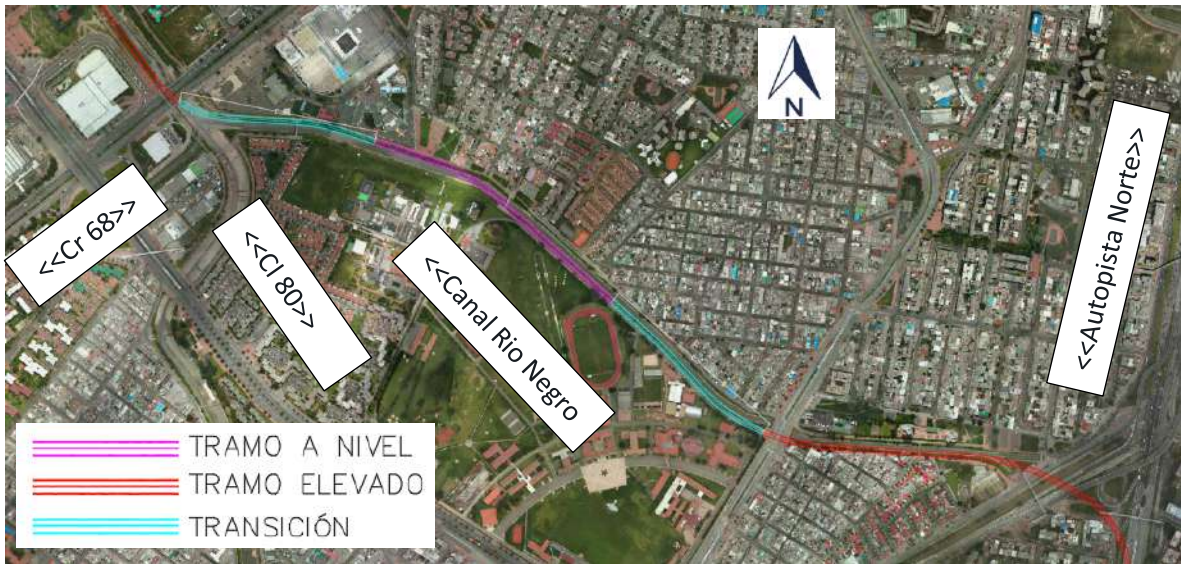
Figura 3.35 Transición entre tipologías elevado y a nivel entre Av. Suba y Cr 68
