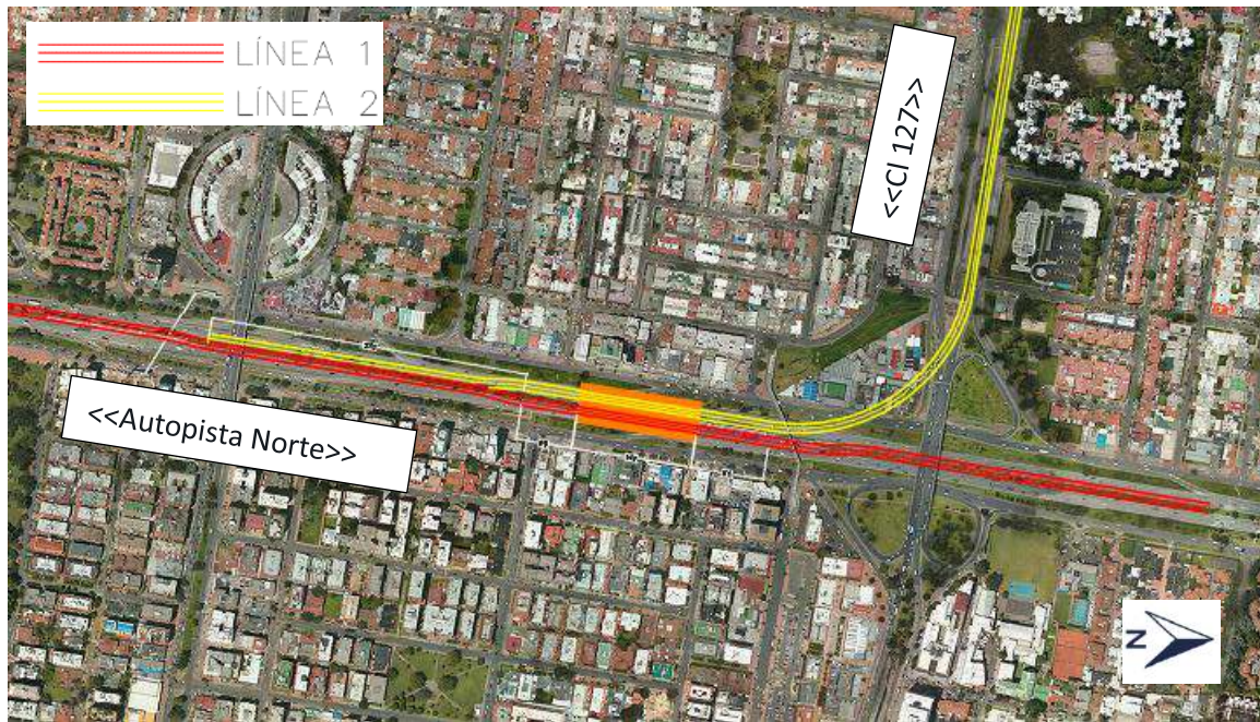
Figura 3.24 Estación de intercambio cl 127 - Extensión PLMB y nueva línea de metro hacia Suba
