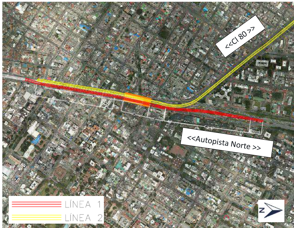
Figura 3.43 Estación de intercambio CI 80- cola de maniobra PLMB y nueva línea de metro hacia Suba
