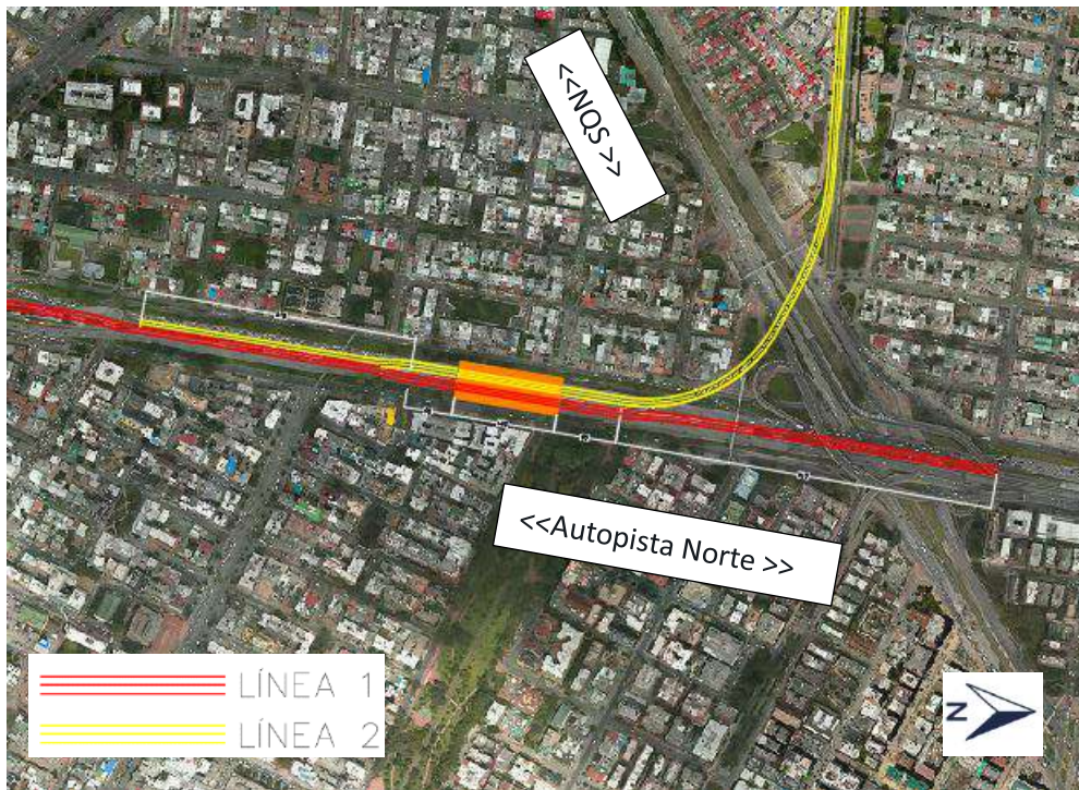
Figura 3.37 Estación de intercambio CI 90- Extensión PLMB y nueva línea de metro hacia Suba
