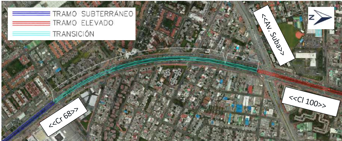
Figura 3.31 Transición entre tipologías elevado y subterráneo
