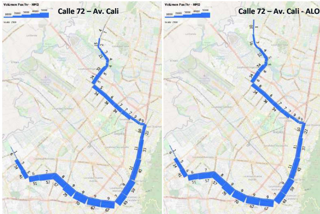
Figura 3.28 Perfil de carga tipología de línea Subterránea
