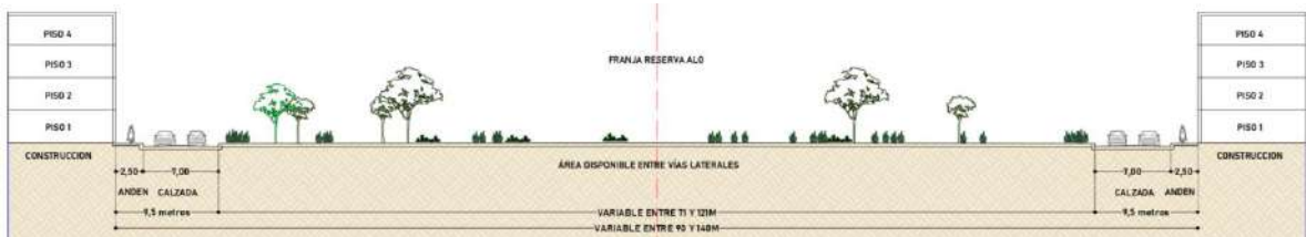
Figura 3.10 Reserva vial Av. ALO entre calle 128 y Av. Suba
