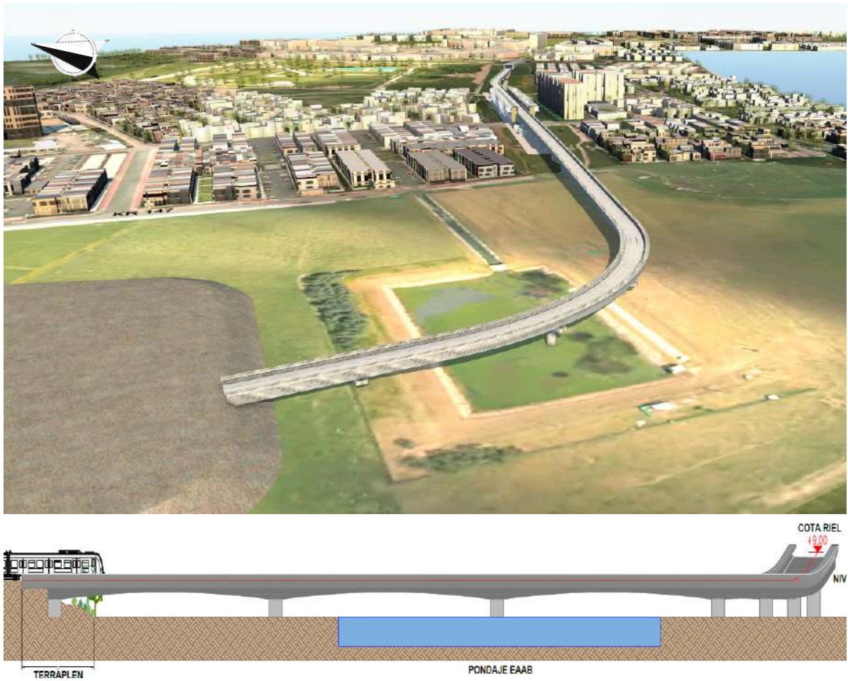
Figura 4.55 - Viaducto en Patio-Taller sobre pondaje EAAB existente
