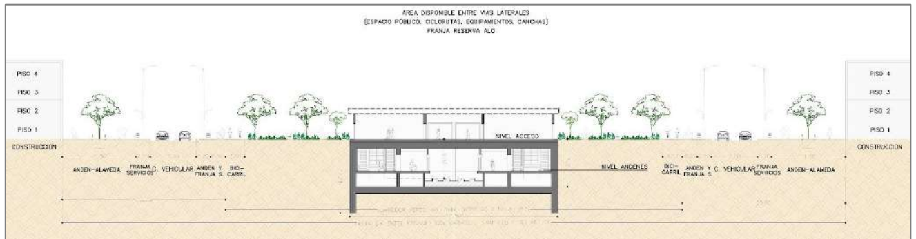
Figura 4.51 Sección vial tramo Estación 9
