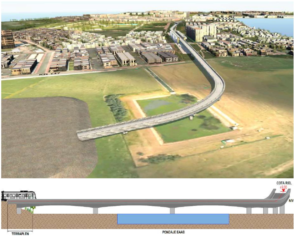
Figura 8.10 - Viaducto en Patio-Taller sobre pondaje EAAB existente
