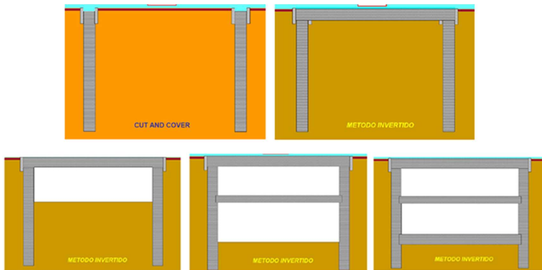
Figura 14. Excavación de pantalla preexcavadas. Cut & Cover. Método invertido.
