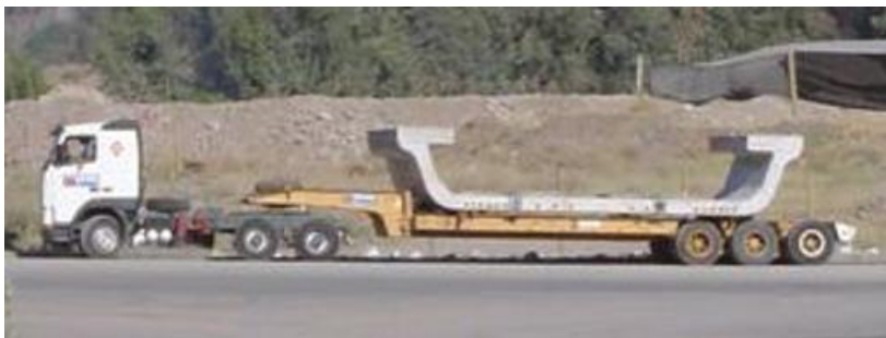
Ilustración 31 - Transporte de dovelas mediante remolques de cama baja
