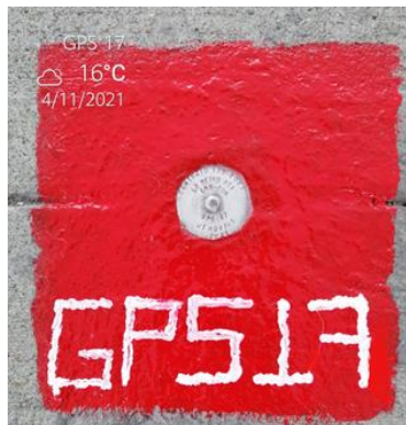
Figura 2. Materialización y placa punto GPS Fuente UT MOVIUS
