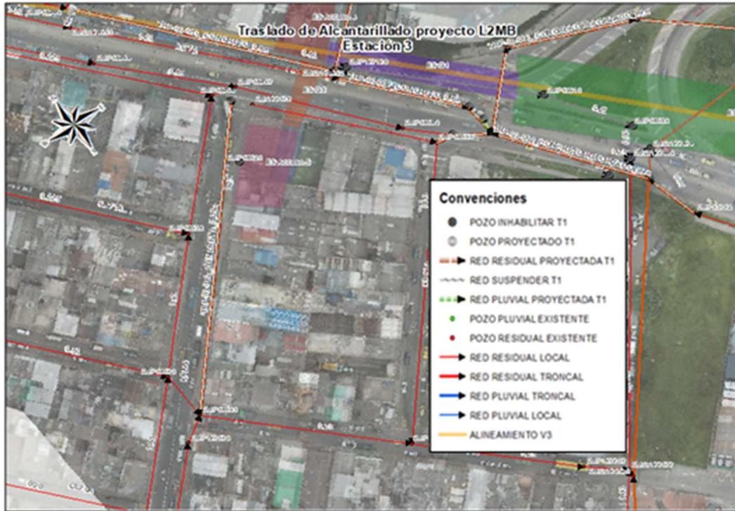
Figura 21. Traslado redes de alcantarillado Estación 3 Calle 72 Carrera 58A costado occidente
