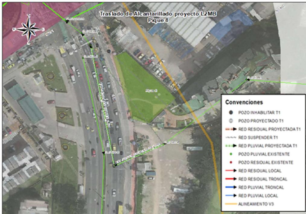
Figura 44. Traslado redes de alcantarillado Pozo de Ventilación 8 Transversal 90C con Carrera 91 - Red Pluvial
