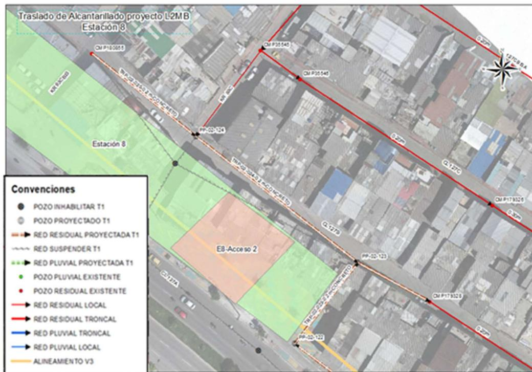
Figura 39. Traslado redes de alcantarillado Estación 8 Carrera 98 con calle 127B Red Residual
