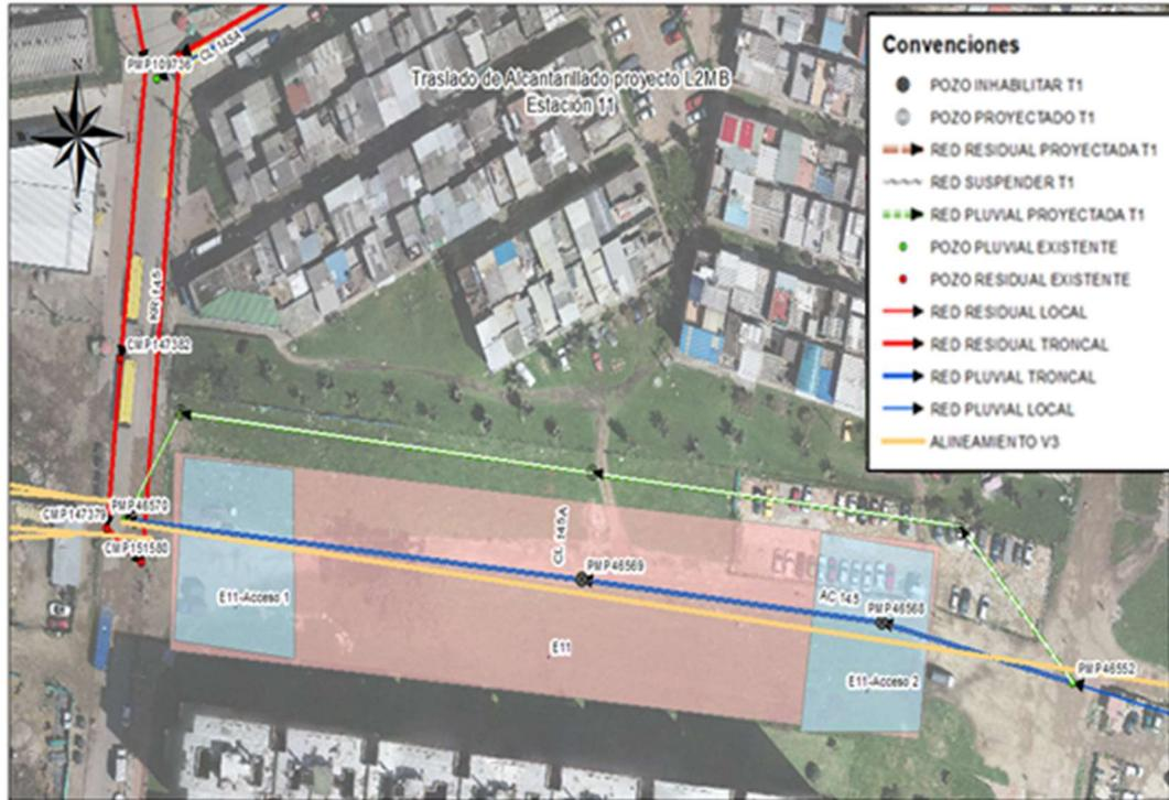
Figura 42. Traslado redes de alcantarillado Estación 11 Calle 145 con carrera 141B
