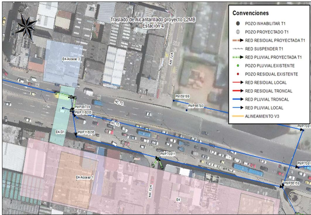
Figura 26. Traslado redes de alcantarillado Estación 4 Calle 72 con Carrera 73A - Red Pluvial
