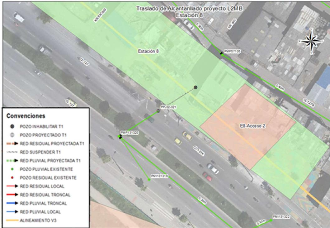
Figura 41. Traslado redes de alcantarillado Estación 8 Carrera 93C con calle 127 Red Residual
