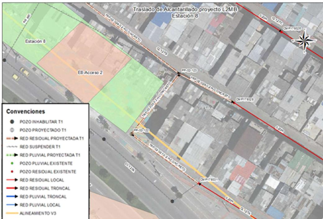
Figura 40. Traslado redes de alcantarillado Estación 8 Carrera 93 con calle 127A Red Residual
