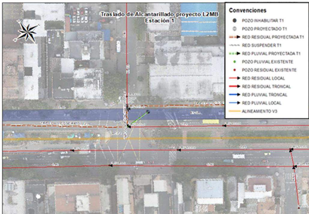
Figura 15. Traslado redes de alcantarillado Estación 1 Calle 72 con Av Caracas Costado Norte
