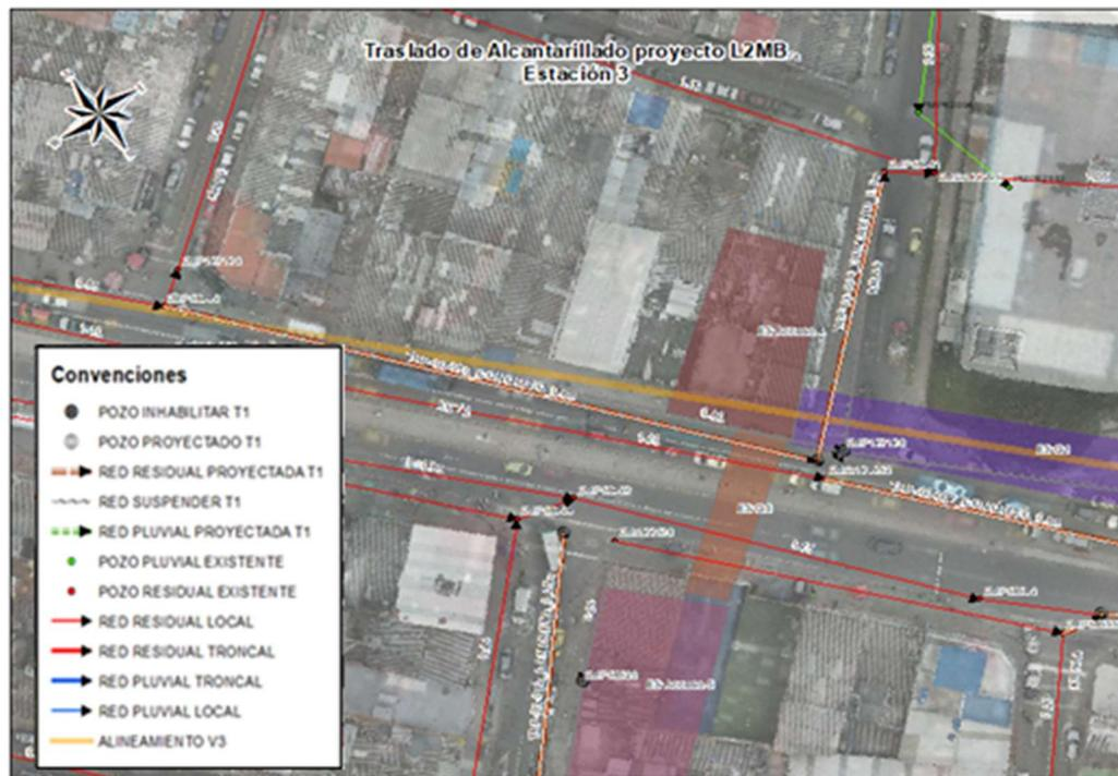
Figura 19. Traslado redes de alcantarillado Estación 3 Calle 72 Carrera 60 Costado norte
