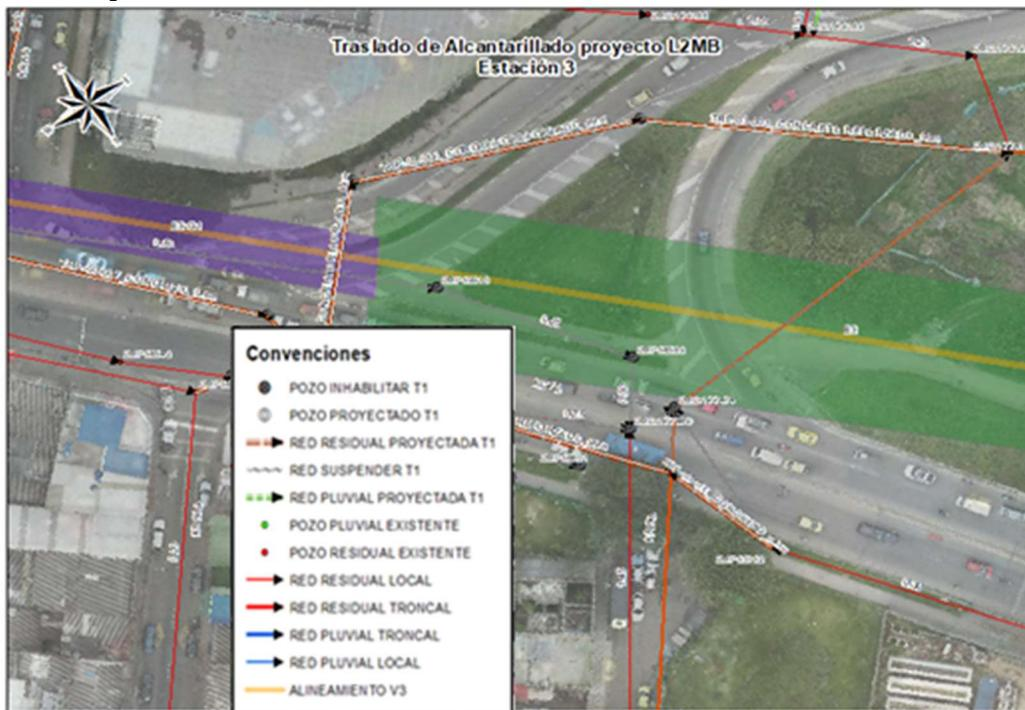
Figura 20. Traslado redes de alcantarillado Estación 3 Calle 72 Carrera 58A
