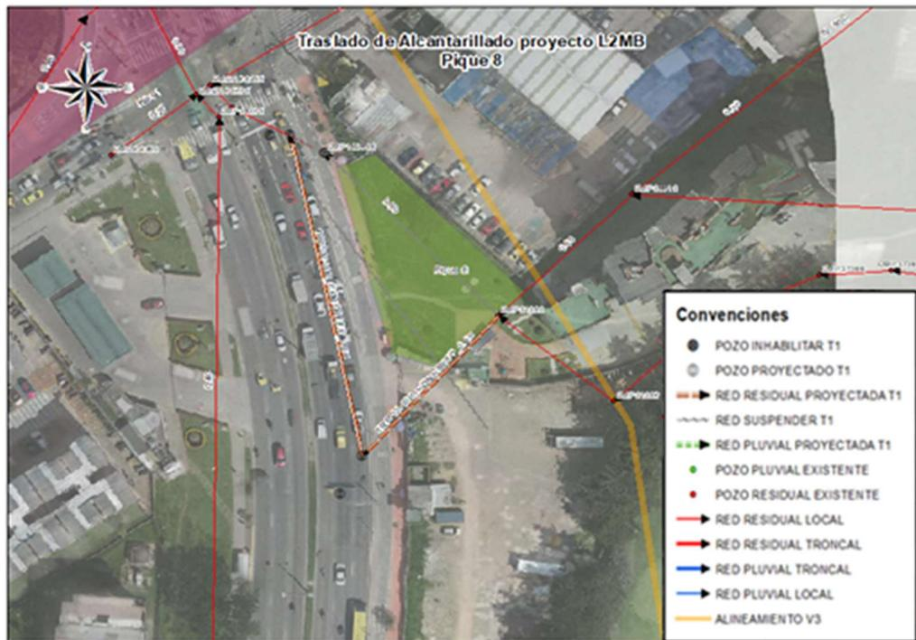
Figura 43. Traslado redes de alcantarillado Pozo de Ventilación 8 Transversal 90C con Carrera 91 - Red Residual
