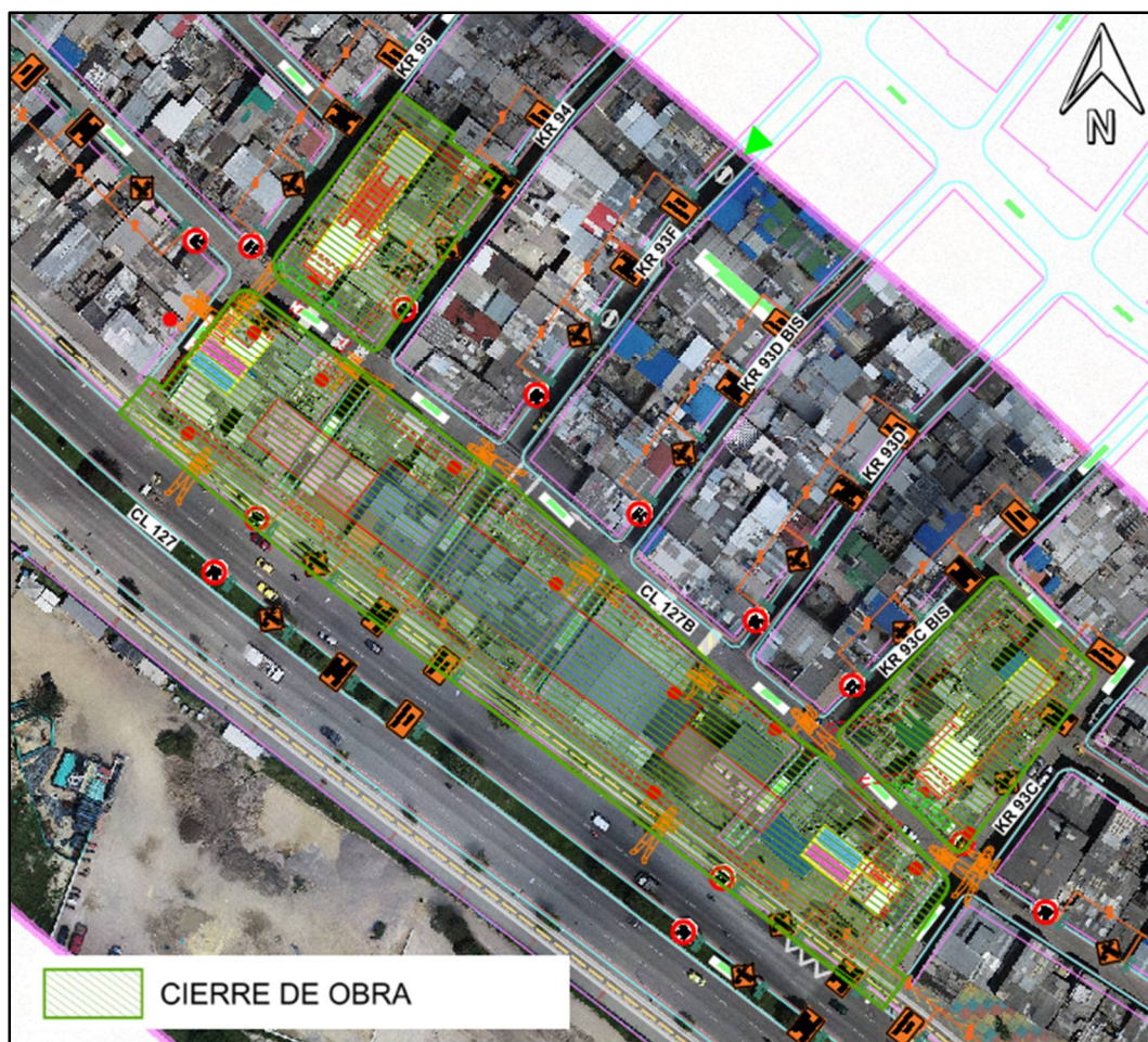
Figura 242. Cierres de obra en Estación 8 - Etapa 1. Fuente: UT MOVIUS 2022
