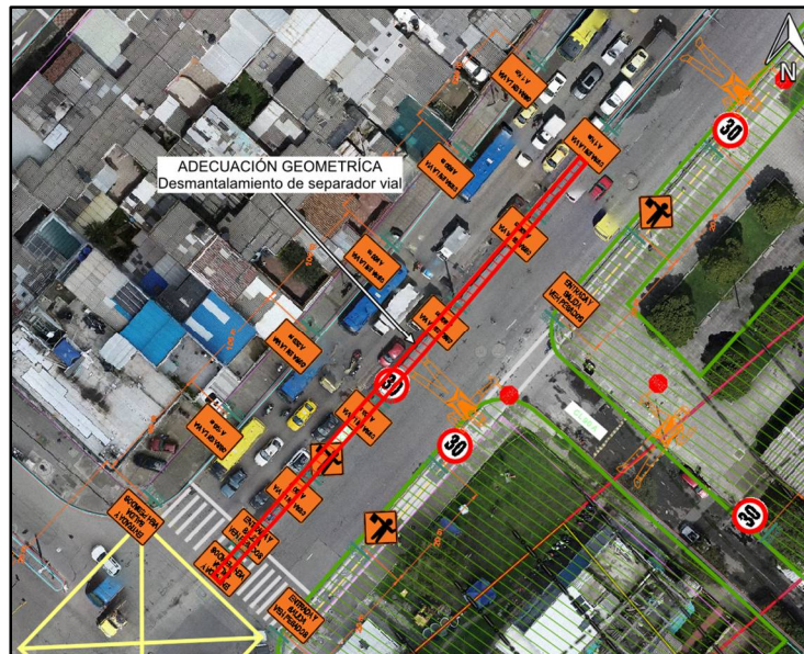
Figura 238. Adecuaciones Geométricas en Estación 7 - Etapa 1. Fuente: UT MOVIUS 2022
