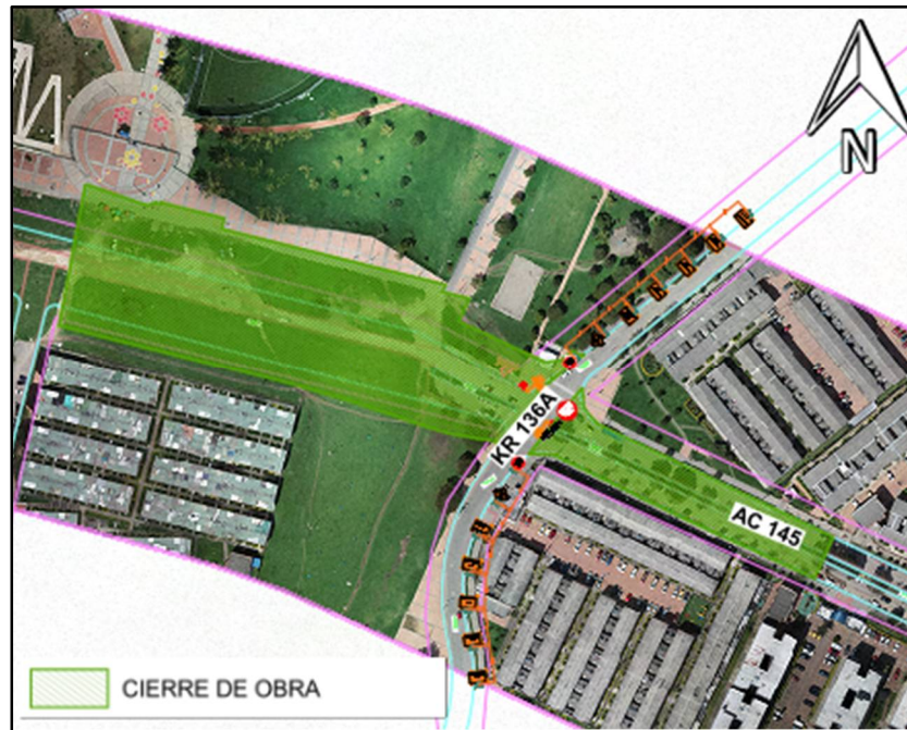
Figura 249. Cierres de obra para el Ingreso de Tuneladora - Etapa 1. Fuente: UT MOVIUS 2022
