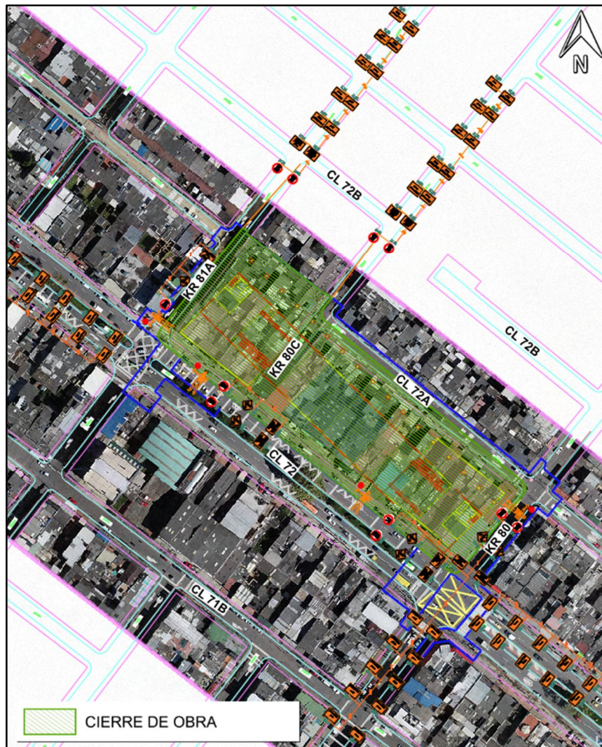
Figura 232. Cierres de obra en Estación 5 - Etapa 1. Fuente: UT MOVIUS 2022
