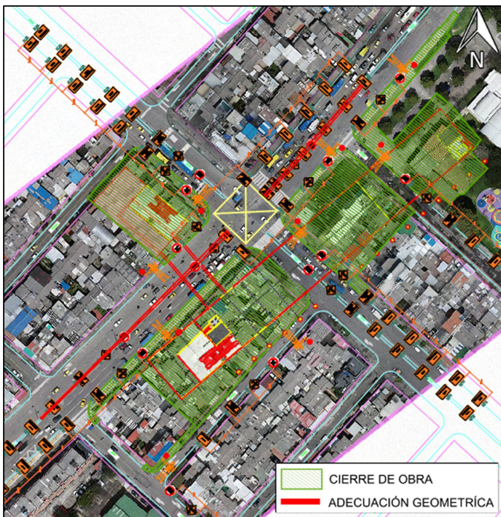
Figura 236. Cierres de obra en Estación 7 - Etapa 1. Fuente: UT MOVIUS 2022
