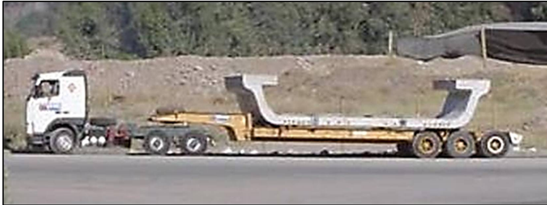
Figura 286. Transporte de dovelas mediante remolques de cama baja Fuente: UT MOVIOUS 2022
