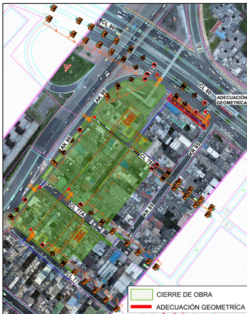
Figura 233. Cierres de obra en Estación 6 - Etapa 1. Fuente: UT MOVIUS 2022
