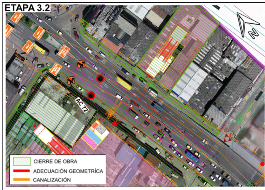
Figura 231. Adecuaciones Geométricas en Estación 4 - Etapa 3. Fuente: UT MOVIUS 2022
