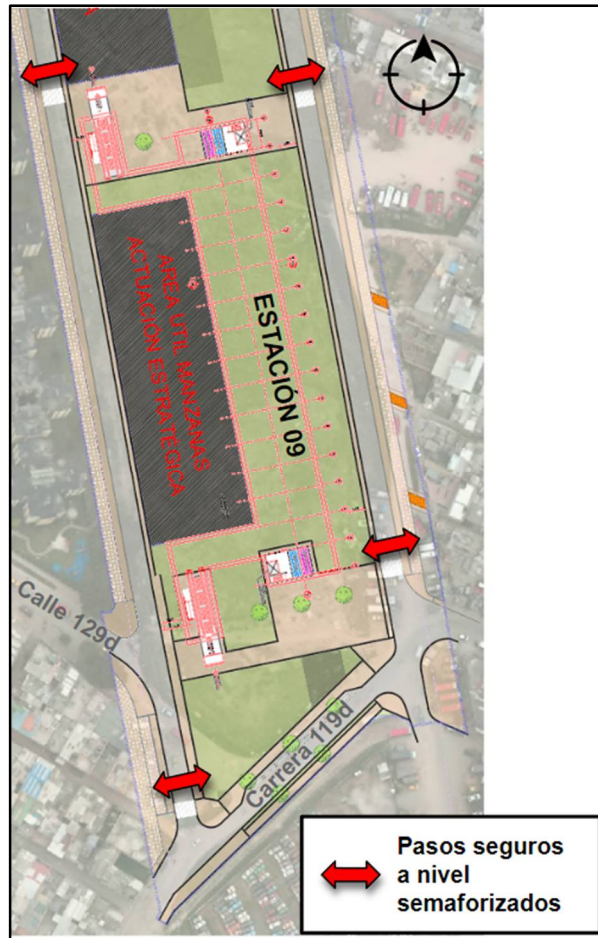
Figura 182. Pasos peatonales semaforizados Estación 9 Fuente: UT MOVIUS 2022
