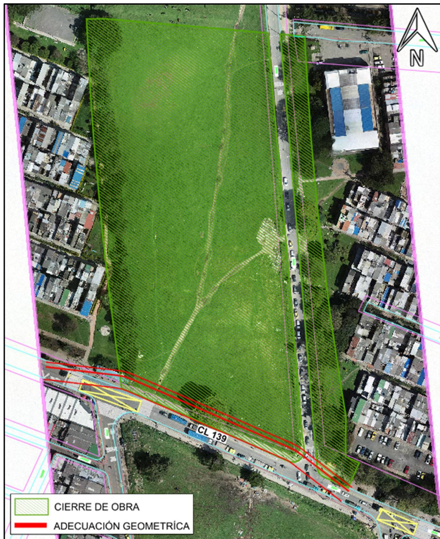
Figura 245. Cierres de obra en Estación 10 - Etapa 1. Fuente: UT MOVIUS 2022
