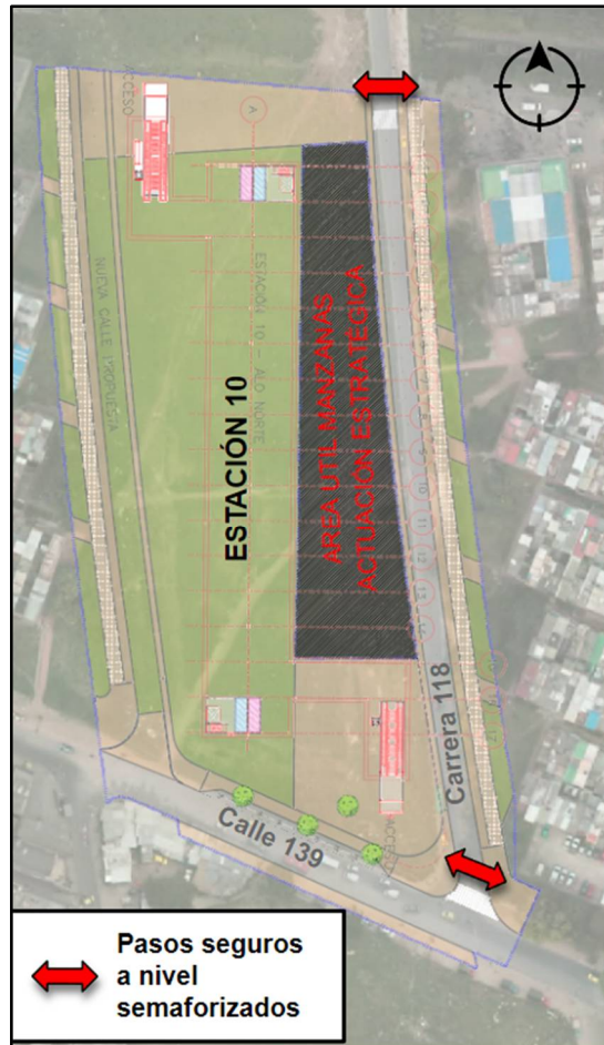
Figura 183. Pasos peatonales semaforizados Estación 10 Fuente: UT MOVIUS 2022
