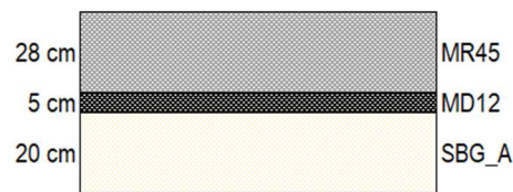
Figura 30. Estructura de pavimento para las vías internas del patio taller
