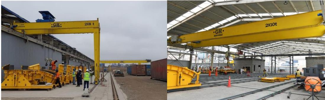
Figura 1. Tipo de equipos e instalaciones requeridos para la planta de dovelas (fuente planta de dovelas línea 2 metro Sao Paulo actualmente en construcción)
