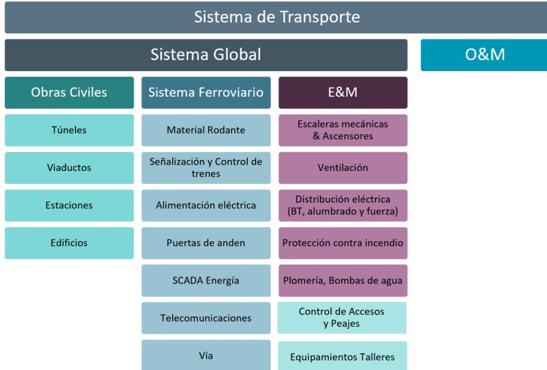
Ilustración 3 - subsistemas y elementos contenidos en el “Sistema de Transporte”
