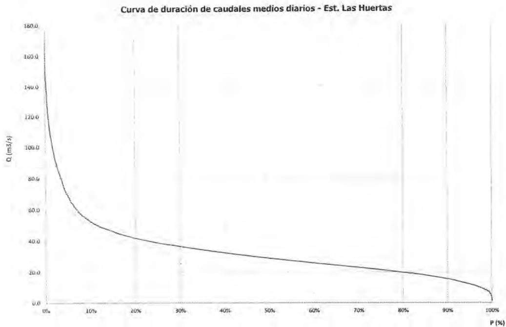
Gráfico 20. Curva de duración de caudales medios diarios – 2120211 Est. Las Huertas Fuente: Elaboración propia.
