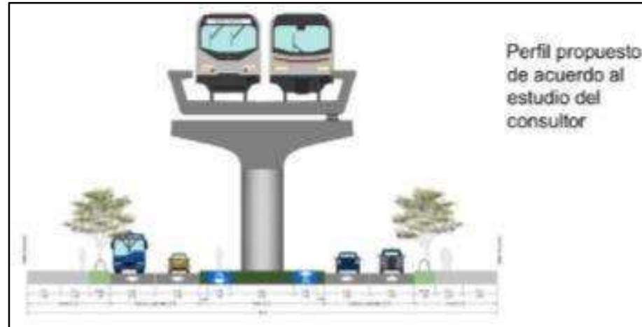
Figura 5. Perfil propuesto Av. Calle 8 Sur.
