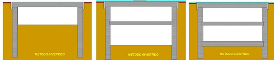
Figura 8. Secuencia de construcción sistema Cut & Cover. Método Invertido. (Top down). Fuente: G. Perri, 2012
