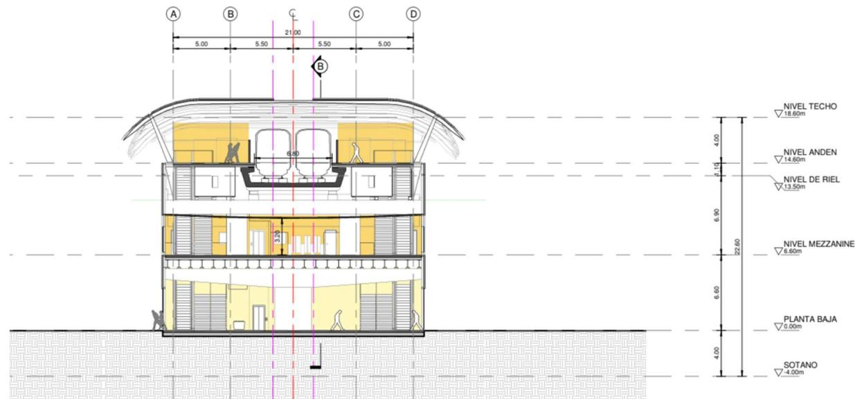
Figura 23. Estación tipo mezzanine PLMB (en construcción)
