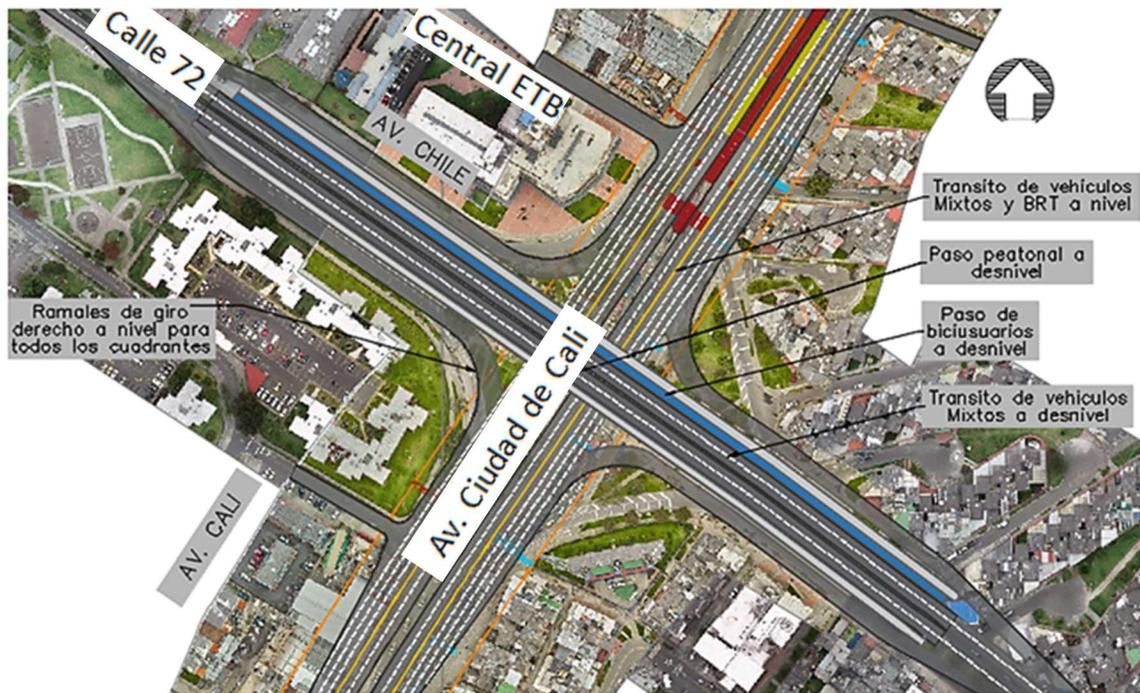
Figura 29. Planta puente proyectado en intersección Av. Ciudad de Cali con Av. Calle 72
