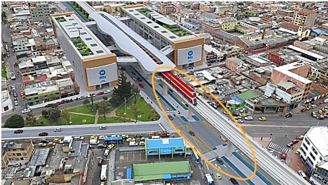
Figura 47. Deprimido Av. Calle 72 con Av. Caracas – Pilas del viaducto de la PLMB sin información a la fecha (localización, dimensiones, separación, cimentación)
